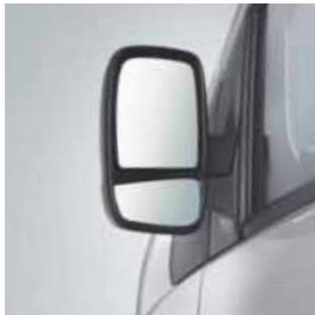
Die Außenspiegel mit Weitwinkelseinsatz sind ausgesprochen hilfreich beim Rangieren. Auf Wunsch sind elektrisch verstell- beheiz- und klappbare Spiegel erhältlich.
